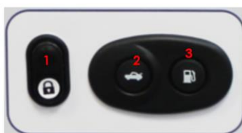
Рисунок 1– Панель управления: 1 – кнопка разблокировки / блокировки двери; 2 – кнопка открывания замка багажника; 3 – кнопка открывания лючка бензобака.
